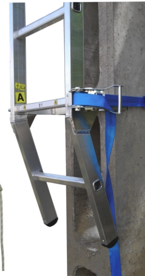
2. A racsnis heveder megfeszítése
